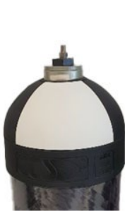
Abb. 4: Zylinder mit kleinem Ventil und 2 bar Innendruck
