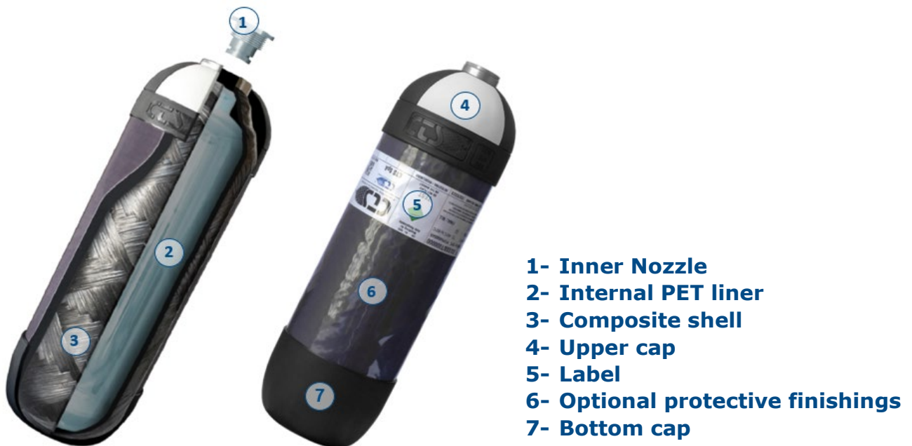
Figure 1. Schéma de composition bouteille CTS
