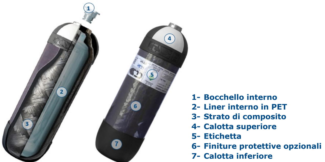
Figura 1. Schema composizione bombola CTS
