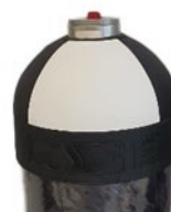
Afb. 6: Cilinder met dop en geen interne druk
