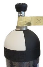
Afb. 7: Cilinder met geopend ventiel en verzegelingstape
