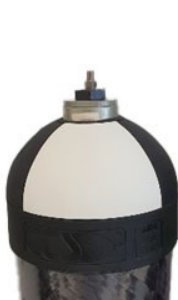
Afb. 4: Cilinder met afsluiter en 2 bar interne druk
