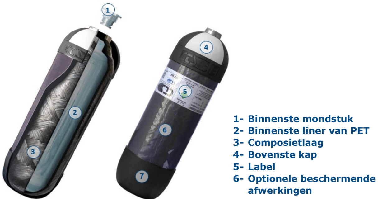
Afbeelding 1. Samenstelling van de cilinders van CTS
