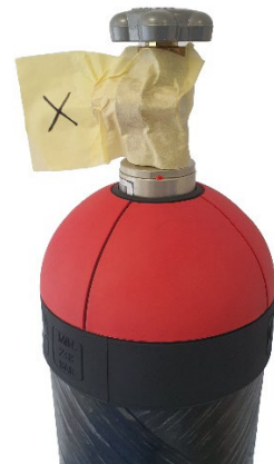
Fig. 7: Cilindro con válvula abierta y cinta antimanipulación
