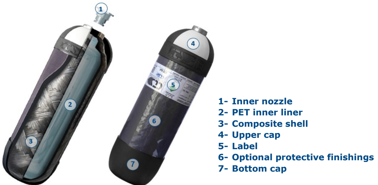
Figura 1. Esquema de composición del cilindro CTS
