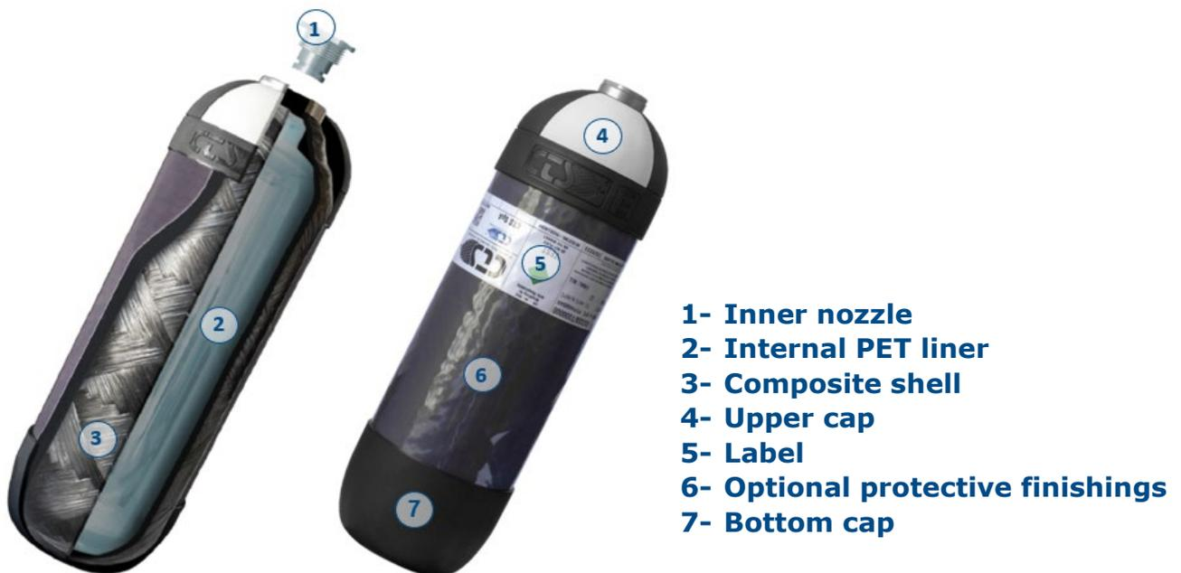
Figure 1. Schéma de composition de la bouteille de la CTS
