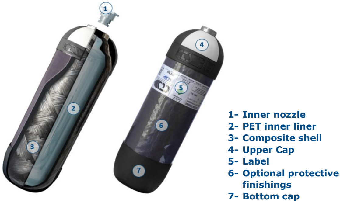
Abbildung 1. Diagramm der CTS-Zylinderzusammensetzung
