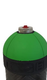
Fig.6: Bouteille avec capuchon et sans pression interne
