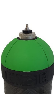
Fig.4: Bombola con valvolina e pressione interna 2 bar
