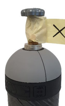
Fig.7: Bombola con valvola aperta e nastro anti-manomissione
