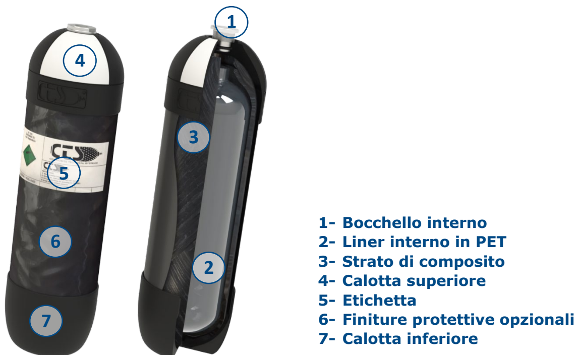
Figura 1. Schema composizione bombola CTS
