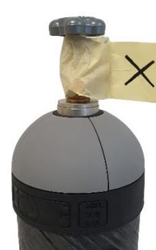
Abb. 7: Zylinder mit offenem Ventil und Manipulationssicherungsband
