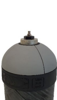
Fig.4: Cilindro con válvula y presión interna 2 bar
