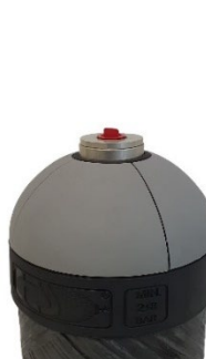
Fig.6: Cilindro con tapón y sin presión interna
