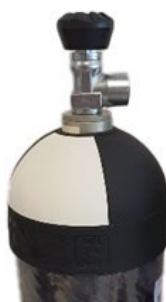
Abb. 5: Zylinder mit Ventil und 2 bar Innendruck
