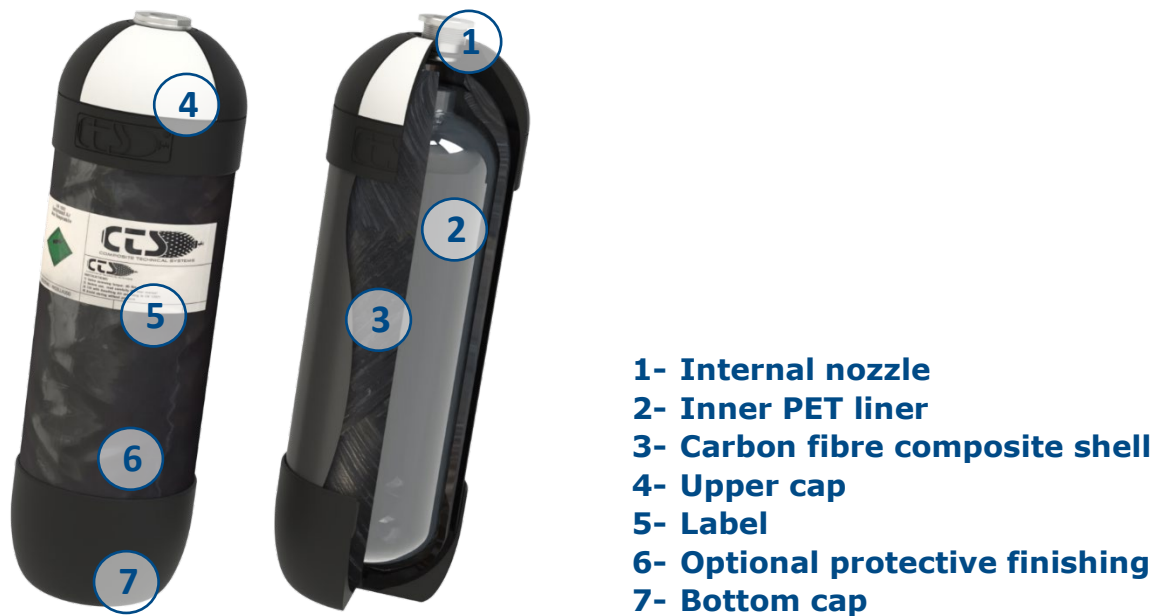
Abbildung 1. Diagramm der CTS-Zylinderzusammensetzung
