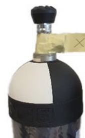
Abb. 7: Zylinder mit offenem Ventil und Manipulationssicherungsband
