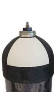
Abb. 4: Zylinder mit kleinem Ventil und 2 bar Innendruck
