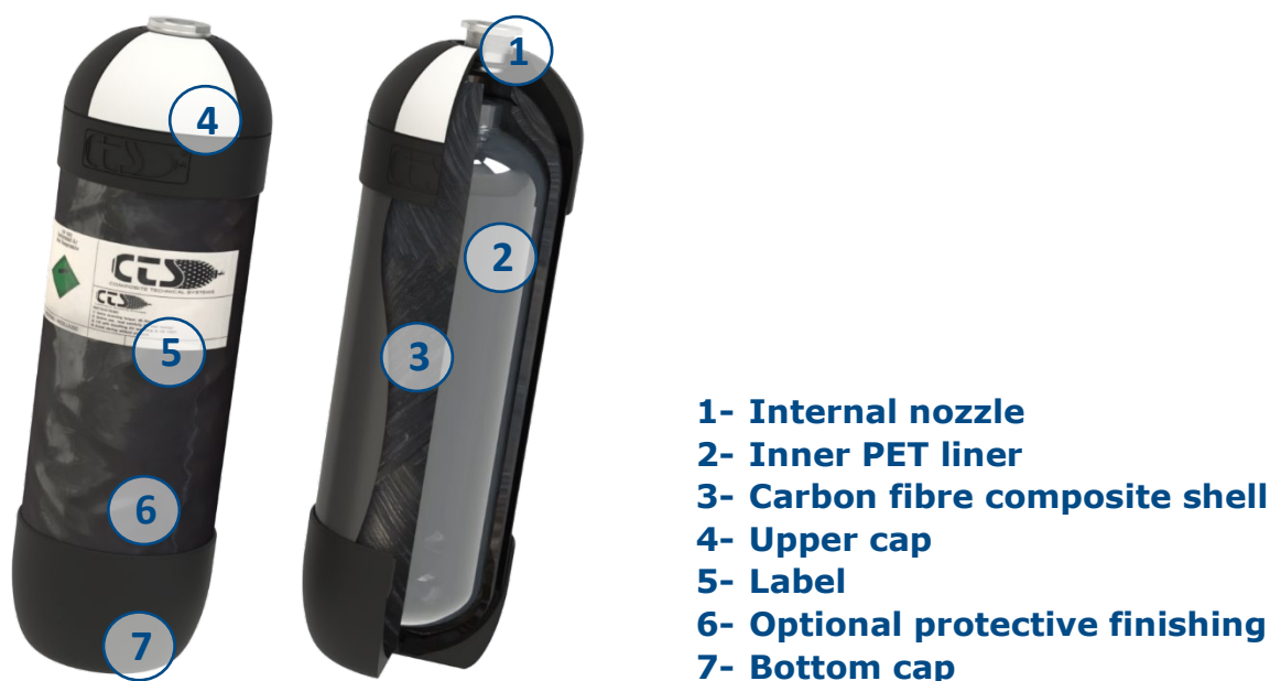
Figura 1. Esquema de composición del cilindro CTS
