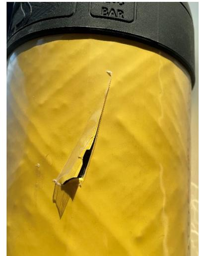
En cas de dommages de niveau 2 pour les bouteilles présentant une finition de protection en fibre de verre, les dommages sont tels que la couche de peinture a complètement disparu et la couche de composite en fibre de verre a été endommagée. L'utilisateur doit s'assurer qu'aucun dommage n'a été transmis au renfort composite en fibre de carbone sous-jacent.
