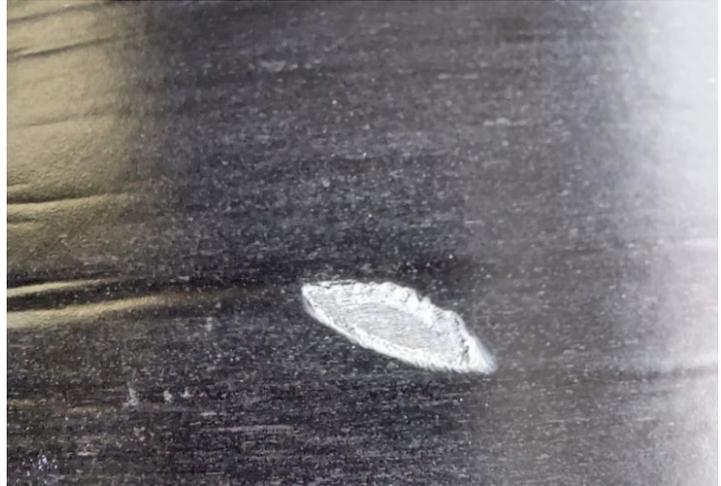
La délamination (voir image ci-dessous) ne doit pas être confondue avec les inclusions d'air piégées, qui sont le résultat d'inclusions d'air au cours du processus de production et se développent notamment autour de l'étiquette. Les inclusions d'air piégées ne constituent pas un problème.
