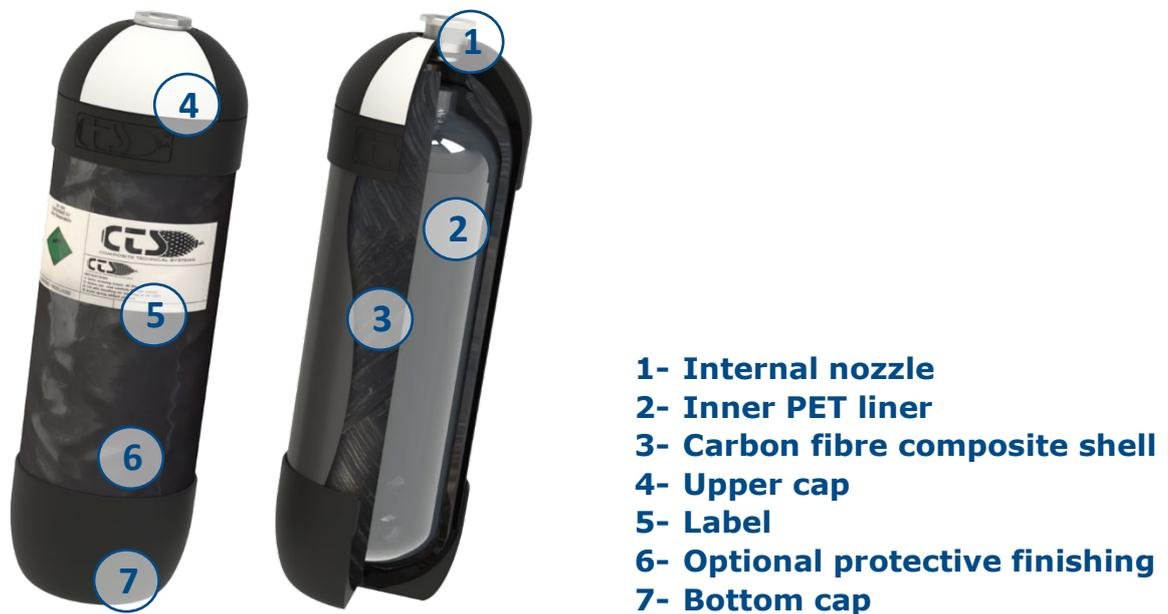
Figure 1. Schéma de composition bouteille CTS
