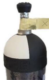
Fig.7 : Bouteille avec vanne ouverte et ruban anti-effraction
