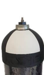
4. ábra: Palack kis szeleppel és 2 bar belső nyomással
