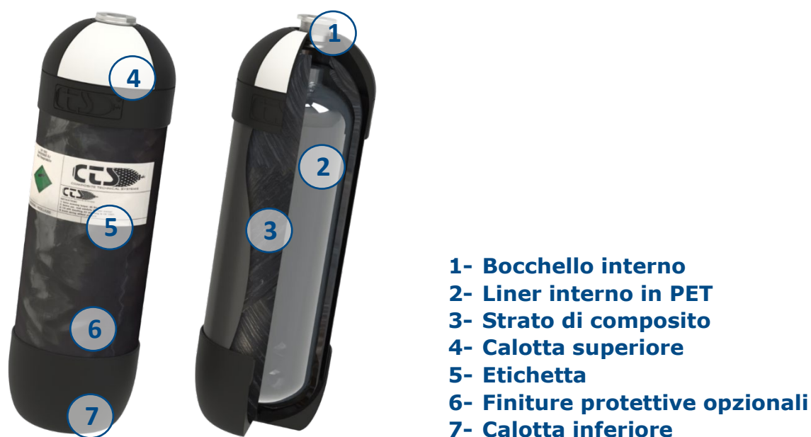
Figura 1. Schema composizione bombola CTS
