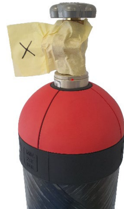
Abb. 7: Zylinder mit offenem Ventil und Manipulationssicherungsband
