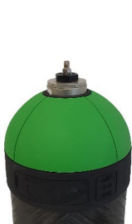
Abb. 4: Zylinder mit kleinem Ventil und 2 bar Innendruck
