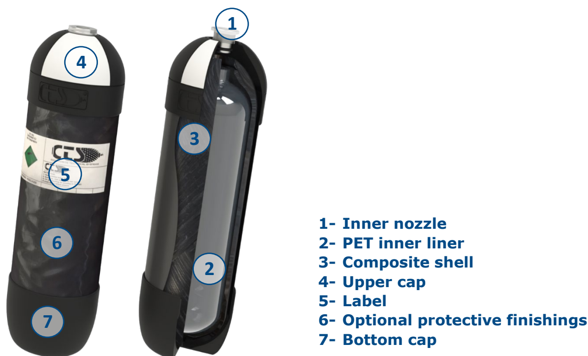
Figura 1. Esquema de composición del cilindro CTS
