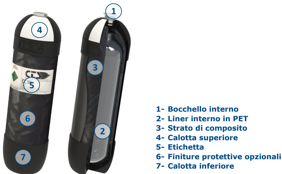
Figura 1. Schema composizione bombola CTS
