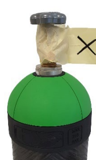
Fig.7: Bombola con valvola aperta e nastro anti-manomissione
