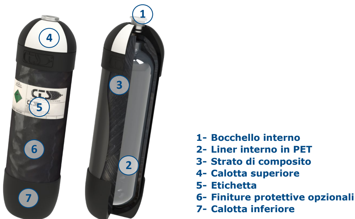
Figura 1. Schema composizione bombola CTS
