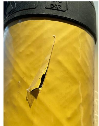
Im Falle von Schäden der Stufe 2 bei Flaschen mit Schutzschicht aus Fiberglas sind die Schäden so groß, dass die Lackschicht und die Schicht aus Fiberglas-Verbundmaterial komplett entfernt wurden. Der Benutzer muss sich versichern, dass keine Beschädigung auf die darunter liegende Verstärkung aus Carbonfaser-Verbundmaterial übertragen wurde.
