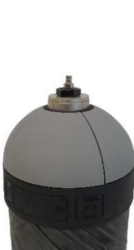
Abb. 4: Zylinder mit kleinem Ventil und 2 bar Innendruck
