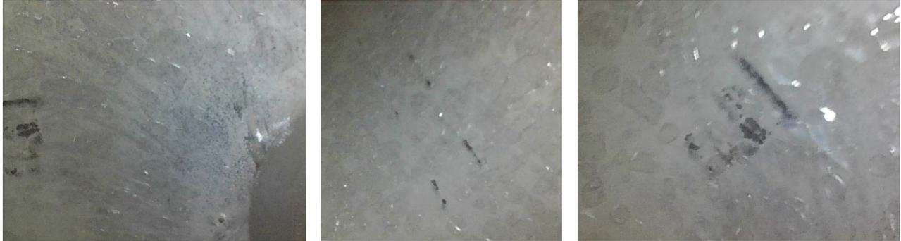
Es posible que ya existan pequeñas imperfecciones en el revestimiento blanco del núcleo. Estas no representan un problema y deben considerarse imperfecciones y no defectos, ya que sirven solamente a efectos de inspección interna y no afectan el funcionamiento del cilindro.
